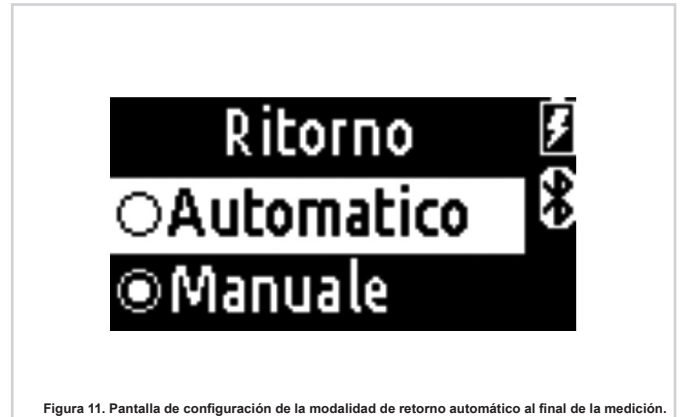
Figura 11. Pantalla de configuración de la modalidad de retorno automático al final de la medición.
