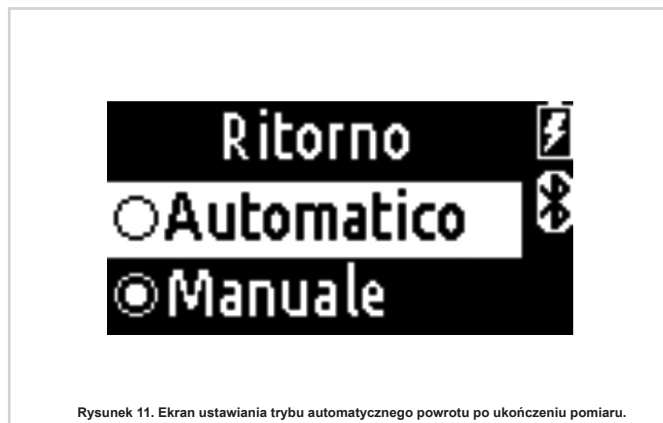
Rysunek 11. Ekran ustawiania trybu automatycznego powrotu po ukończeniu pomiaru.
